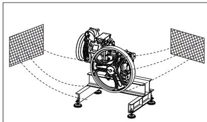
Deve essere ventilato: il locale deve avere adeguate aperture o condizioni per permettere un ricambio d'aria sufficiente a smaltire il calore ceduto dal motore elettrico e dal riduttore.
