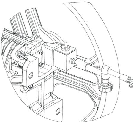
4. Posizionare il comparatore sul raggio della puleggia di trazione alla distanza A dal centro dell'albero. Assicurarsi che il comparatore sia tangente al diametro di misurazione. La distanza A è indicata nella tabella 2 sottostante e dipende dalla taglia del riduttore.
