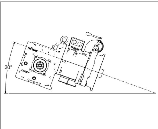
Durante il sollevamento e trasporto dell'argano accertarsi che lo stesso non assuma posizioni, inclinate rispetto all'orizzontale, superiori ad un angolo di 20° se inclinato dalla parte del motore poiché l'olio contenuto nell'argano potrebbe fuoriuscire. Qualora fosse necessario trasportare l'argano in posizione inclinata per più di tali angoli ordinare l'argano specificando la richiesta di fornitura con "olio a parte".
