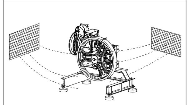
Deve essere ventilato: il locale deve avere adeguate aperture o condizioni per permettere un ricambio d'aria sufficiente a smaltire il calore ceduto dal motore elettrico e dal riduttore.
