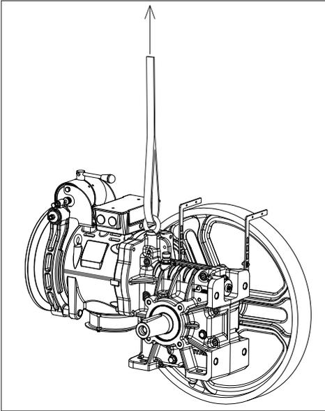
Nella movimentazione dell'argano disimballato, utilizzare una gru o un carrello a forche larghe di portata adeguata, utilizzando in sospensione il golfare del riduttore e una fascia non metallica attorno al motore.
