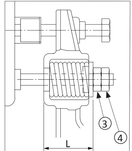
Va considerato che a seguito dell'usura dei ferodi il livello di compressione delle molle tende a diminuire riducendo la capacità frenante. In tali condizioni l'aumento del solo precarico della molla come regolazione è considerato un errore, in quanto l'operazione va associata anche ad una regolazione della corsa.
